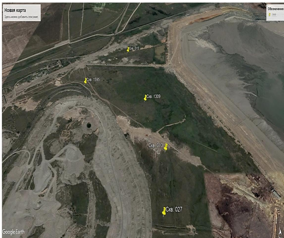
Рисунок 2.1 – Схема расположения наблюдательных скважин
